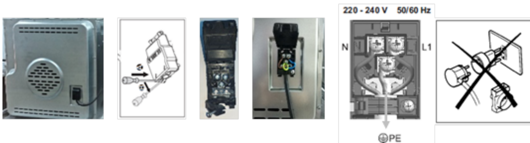
Фигура 2: Свързване на електрическия щепсел на фурната
