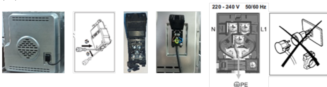
Фигура 2: Свързване на електрическия щепсел на фурната
