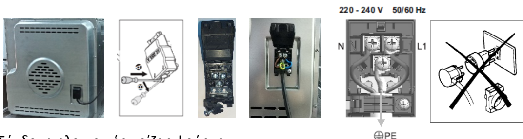
Σχήμα 2: Σύνδεση ηλεκτρικής πρίζας φούρνου
