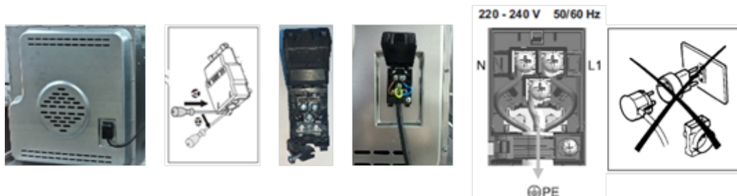
Фигура 2: Свързване на електрическия щепсел на фурната
