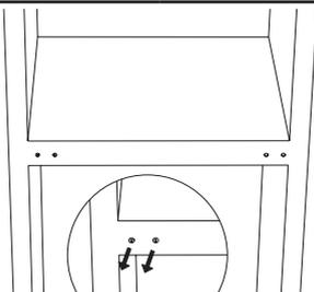
11. Podnieś urządzenie i umieść drzwi na dolnym zawiasie. Upewnij się, że dolny zawias jest wsunięty w otwór w drzwiach. Następnie przesuń osłonę otworu dolnego zawiasu drzwi z lewej strony na prawą.
