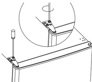
14. Klepněte na kryt pantu a kryt otvoru na horní straně jednotky.
