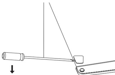
4. Przesuń osłonę rdzenia z lewej strony na prawą. Następnie podnieś górne drzwiczki i umieść je na wyściętanej powierzchni, aby zapobiec zarysowaniu.
