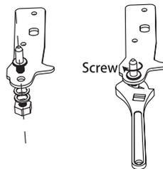
9. Așezați balamaua pe partea stângă și baza piciorului pe partea dreaptă. Apoi, înșurubați două picioare de nivelare la piesele lor originale.
