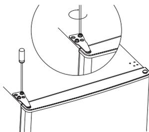
14. Atingeți capacul balamalei și capacul orificiului din partea de sus a unității.
