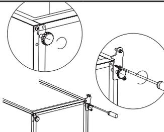
8. Schrauben Sie den unteren Scharnierstift ab, entfernen Sie ihn, drehen Sie die Halter-
