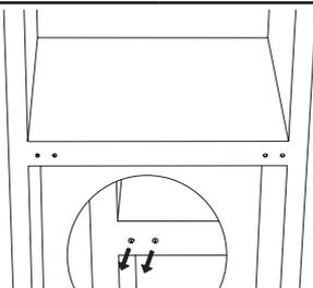
11. Zvedněte jednotku a umístěte dveře na spodní závěs. Ujistěte se, že je spodní závěs zasunut do otvoru ve dveřích. Poté přesuňte kryt otvoru pro spodní závěs dveří z levé strany na pravou stranu.
