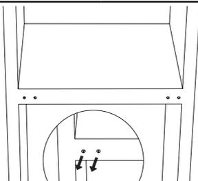
11. Ridicați unitatea și așezați ușa pe balamaua inferioară. Asigurați-vă că balamaua inferioară este introdusă în orificiul din ușă. Apoi mutați capacul inferioară a orificiului balamalei ușii din partea stângă în partea dreaptă.
