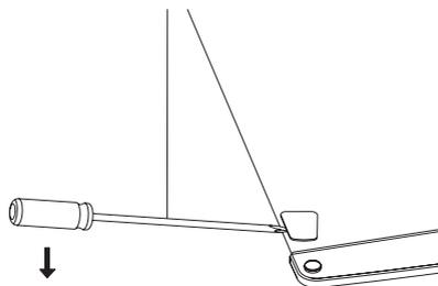
4. Přesuňte kryt jádra z levé strany na pravou stranu. Poté zvedněte horní dvířka a položte je na polstrovaný povrch, abyste zabránili poškrábání.
