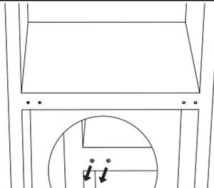
7. Legen Sie die Rückseite des Schrankes auf ein weiches Kissen. Und schrauben Sie das untere Scharnier und den Nivellierfuß ab.
