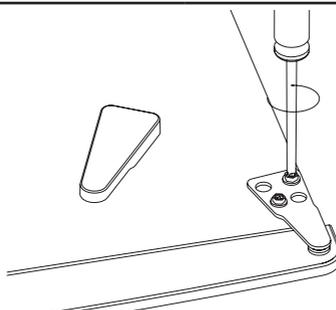
3. Odstraňte kryt otvoru pomocí plochého šroubováku.
