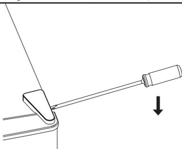
2. Deşurubaţi balamaua superioară cu o şurubelniţă.
