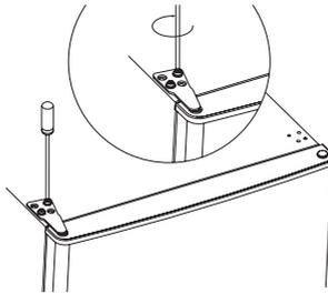
14. Klopfen Sie auf die Scharnierabdeckung und die Lochabdeckung oben am Gerät.
