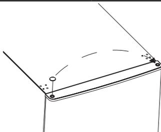
5. Deșurubați balamaua din mijloc, apoi ridicați ușa inferioară și așezați-o pe un suport moale pentru a preveni zgârieturile.
