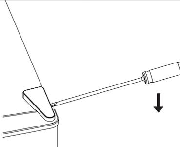
2. Schrauben Sie das obere Scharnier mit einem Schraubendreher ab.
