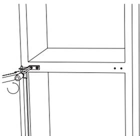
13. Namontujte horní dvířka s horním závěsem.
