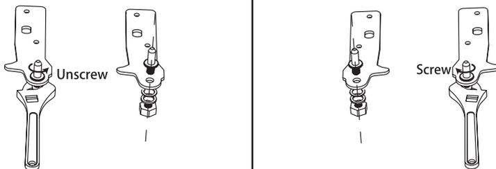
9. Τοποθετήστε τον μεντεσέ στην αριστερή πλευρά και τη βάση του ποδιού στη δεξιά πλευρά. Στη συνέχεια, βιδώστε δύο πόδια ισοπέδωσης με τα αρχικά τους μέρη.
