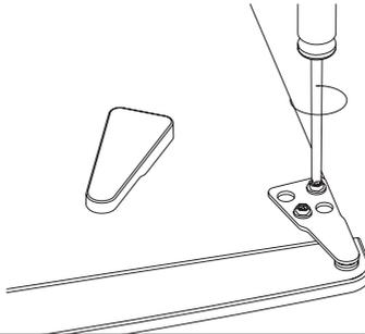
3. Entfernen Sie die Lochabdeckung mit einem flachen Schraubendreher.
