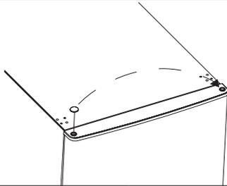
5. Schrauben Sie das mittlere Scharnier ab, heben Sie dann die untere Tür an und legen Sie sie auf eine weiche Unterlage, um Kratzer zu vermeiden.
