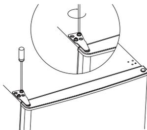
14. Dotknij pokrywy zawiasów i pokrywy otworu w górnej części urządzenia.
