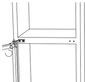
13. Zamontować górne drzwi z górnym zawiasem.
