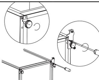
8. Odšroubujte a vyjměte čep spodního závěsu, otočte držák a namontujte zpět.
