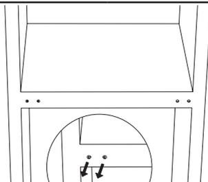
7. Položte zadní část skříně na měkký polštář. A odšroubujte spodní závěs a vyrovnávací nožku.
