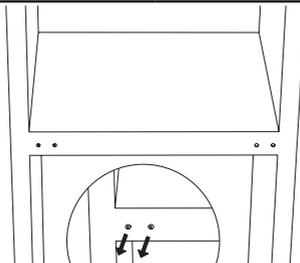
7. Așezați spatele dulapului pe o pernă moale. Și deșurubați balamaua inferioară și piciorul de nivelare.
