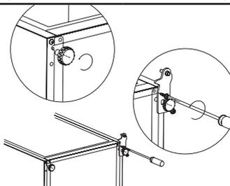
8. Ξεβιδώστε και αφαιρέστε τον πείρο του κάτω μεντεσέ, γυρίστε το στήριγμα και επανατοποθετήστε το.
