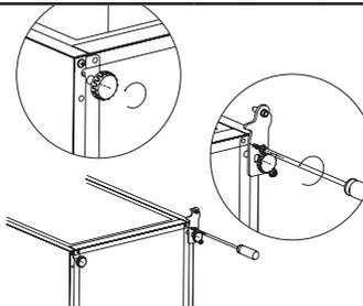
8. Odkręć i wyjmij sworzeń dolnego zawiasu, obróć wspornik i zamontuj ponownie.
