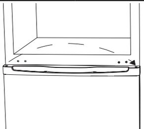
12. Installieren Sie das mittlere Scharnier.
