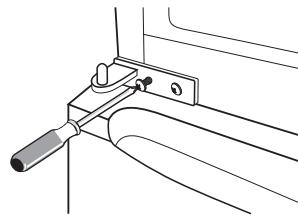
10. Nasadte zpět horní dvířka. Před konečným utažením horního závěsu se ujistěte, že jsou dvířka vyrovnána vodorovně a svisle, aby bylo těsnění na všech stranách uzavřeno.
