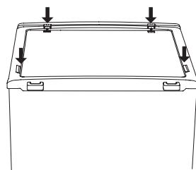
12. Odpojte těsnění dveří chladničky a mrazničky a po otočení je připevněte.
