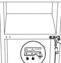
4. Odšroubujte střední závěs. Poté zvedněte spodní dvířka a položte je na měkkou podložku, aby nedošlo k jejich poškrábání.
