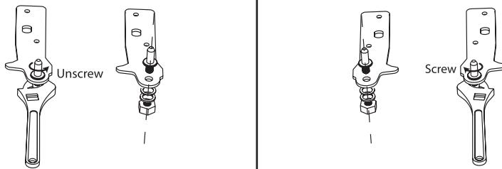
8. Namontujte zpět držák na čep spodního závěsu. Vyměňte obě nastavitelné nožičky.
