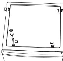
2. Odšroubujte horní pant a poté sejměte horní dvířka a položte je na měkký, aby nedošlo k poškrábání.
