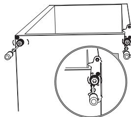
7. Odkręć i wyjmij sworzeń zawiasu dolnego, odwróć wspornik i wymień go.
