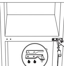
4. Mittleres Scharnier abschrauben. Heben Sie dann die untere Tür an und legen Sie sie auf eine weiche Unterlage, um Kratzer zu vermeiden.
