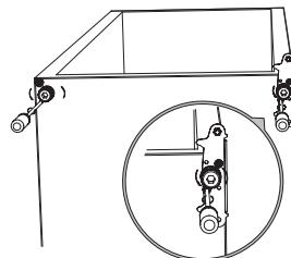
7. Schrauben Sie den unteren Scharnierstift ab, entfernen Sie ihn, drehen Sie die Halterung um und setzen Sie sie wieder ein.
