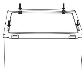
12. Nehmen Sie die Türdichtungen des Kühl- und Gefrierschranks ab und bringen Sie sie nach dem Drehen wieder an.
