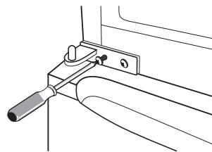
10. Załącz z powrotem górne drzwiczki. Upewnij się, że drzwi są wyrównane poziomo i pionowo, tak aby uszczelka była zamknięta ze wszystkich stron przed ostatecznym dokręceniem górnego zawiasu. Następnie zobojętnij zawias i przykręć go do górnej części urządzenia.
