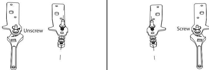
8. Remontați suportul de fixare a știftului balamalei de jos. Înlocuiți ambele picioare reglabile. Transferați ușa inferioară în poziția proprietății.
