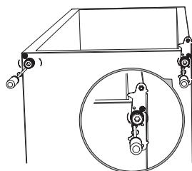
7. Ξεβιδώστε και αφαιρέστε τον πείρο του κάτω μεντεσέ, γυρίστε το στήριγμα και επανατοποθετήστε το.
