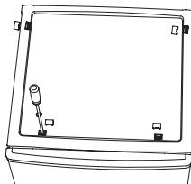
2. Deșurubați balamaua superioară și apoi scoateți ușa superioară și așezați-o pe un suport moale pentru a evita zgârieturile.
