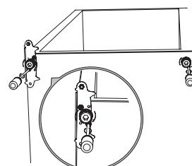
9. Faceți balamaua din mijloc să inverseze direcția cu 180°C, apoi transferați-o în poziția de proprietate din stânga. Faceți știftul balamalei din mijloc în orificiul superior al ușii inferioare, apoi strângeți șuruburile.
