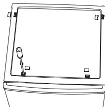
2. Schrauben Sie das obere Scharnier ab, nehmen Sie dann die obere Tür ab und legen Sie sie auf eine weiche Unterlage, um Kratzer zu vermeiden.
