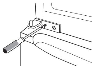
10. Setzen Sie die obere Tür wieder auf. Stellen Sie sicher, dass die Tür horizontal und vertikal ausgerichtet ist, sodass die Dichtung an allen Seiten geschlossen ist, bevor Sie das obere Scharnier endgültig festziehen. Anschließend das Scharnier einhängen und an der Oberseite des Gerätes festschrauben.
