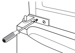
10. Puneți la loc ușa superioară. Asigurați-vă că ușa este aliniată orizontal și vertical, astfel încât etansarea să fie închisă pe toate părțile înainte de a strânge definitiv balamaua superioară. Apoi inserți balamaua și înșurubați-o în partea de sus a unității.
