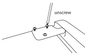
3. Αφαιρέστε τον πείρο με ένα κατσαβίδι και γυρίστε το στήριγμα του μεντεσέ. Στη συνέχεια τοποθετήστε ξανά τον πείρο στο στήριγμα μεντεσέδων.
