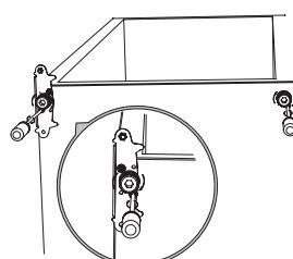
9. Drehen Sie das mittlere Scharnier um 180 °C um und bringen Sie es dann in die linke Objektposition. Setzen Sie den mittleren Scharnierstift in das obere Loch der unteren Tür ein und ziehen Sie dann die Schrauben fest.
