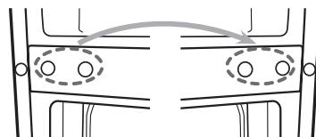
6. Schrauben Sie das untere Scharnier ab. Entfernen Sie dann die verstellbaren Füße auf beiden Seiten.
