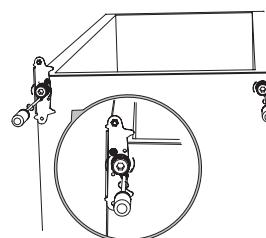
9. Otočte prostřední závěs o 180°C a přemístěte jej do polohy vlevo. V horním otvoru spodních dvířek vytvořte čep středního závěsu a poté utáhněte šrouby.
