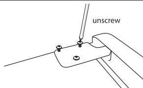
3. Entfernen Sie den Stift mit einem Schraubendreher und klappen Sie die Scharnierhalterung um. Bringen Sie dann den Stift wieder an der Scharnierhalterung an.
