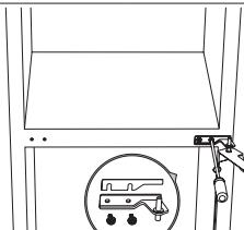
4. Deșurubați balamaua din mijloc. Apoi ridicăți ușa inferioară și așezați-o pe un tampon moale pentru a evita zgârieturile.
