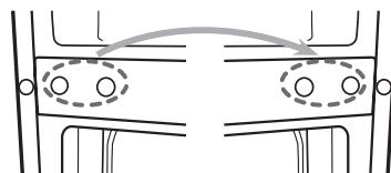
6. Deșurubați balamaua inferioară. Apoi scoateți picioarele reglabile din ambele părți.
